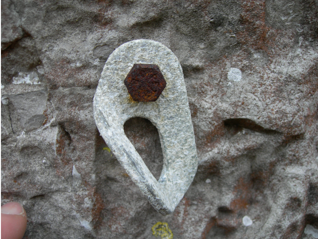
Aluminium hanger, steel bolt.
